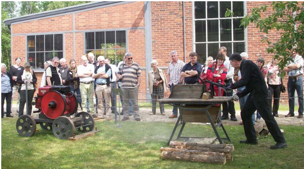
Här visas en gammal vedsåg remdriven av en flyttbar tändkulemotor.
