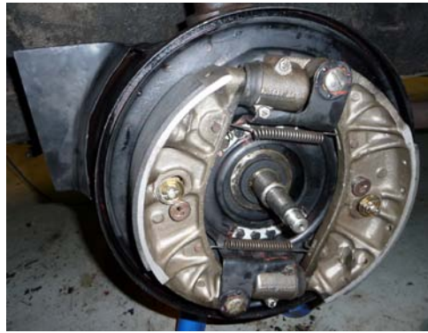
Stora lättmetallbackar med dubbla cylindrar.
