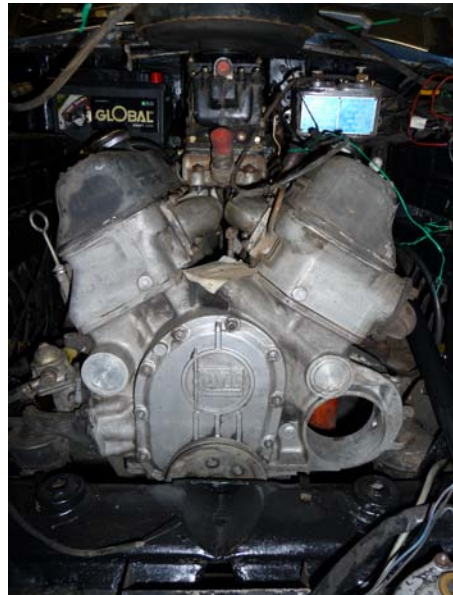
Stora lättmetallbackar med dubbla cylindrar.
