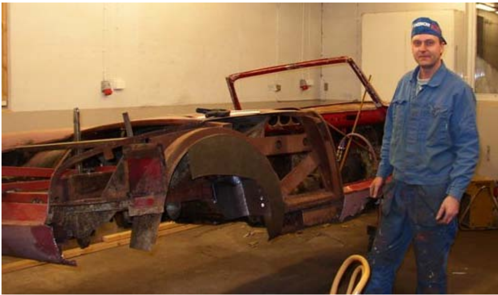
Mikael Kühne började renoveringen år 1990 med borttagning av rostskadade partier.
