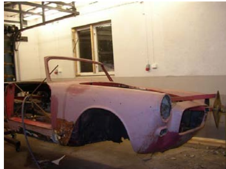
Mikael Kühne började renoveringen år 1990 med borttagning av rostskadade partier.
