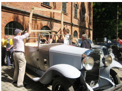
Några bilar från Nordbergs Karosserifabrik i Stockholm visades upp. Här ett finsnickeri i trä till suflettstommen på en vacker bil bredvid en vackert byggd Volvokaross.
