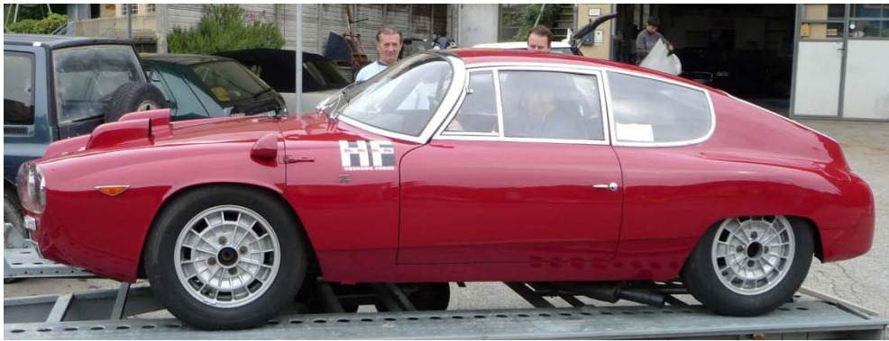
Här ses karossens och glastrutornas modifiering samt Cromodorafälgarna med 185/70 x 15.
