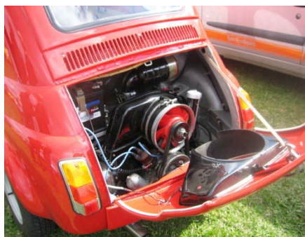
4-cylindrig vattenkyld motor fram som i en Fiat 500 C eller en luftkyld 2-cylindrig bak som i denna österrikisk-byggda Fiat-Puch.
