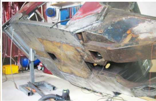
Hela det släta golvet är en enda stor lådkonstruktion och här visar han upp den lagade bakluckan för reservhjulet.
