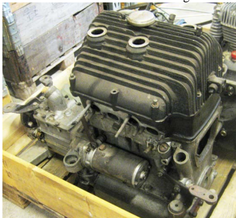
Paganimotorn med cross-flow –topplocket minsann Framaxel med lätthål +mycket annat
