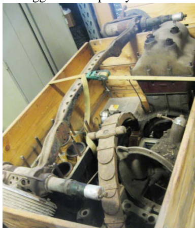
Paganimotorn med cross-flow –topplocket minsann Framaxel med lätthål +mycket annat
