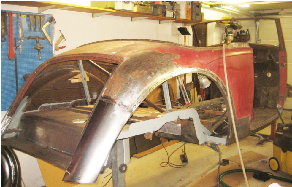
Henry Nesselqvist jobbar skickligt på med de avancerade plåtarbetena på Aprilia Cabrioleten.
