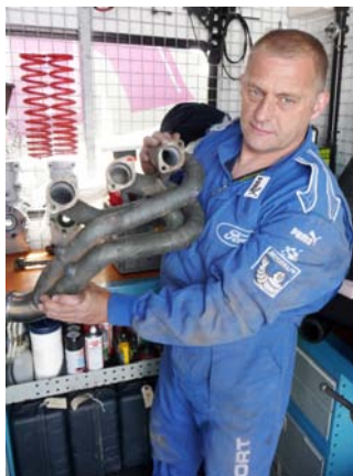
Lancia Stratos-avgasrör för tävling och finjustering av insprutningsmotorn gjordes i depån.
