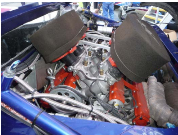
Lancia Stratos-avgasrör för tävling och finjustering av insprutningsmotorn gjordes i depån.
