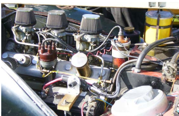
Motorn typ 85 C, är en rak 6-cyl. med 2 liters volym på 100 hk, och originalutrustad med platinatändstift med M10-gänga och tyvärr bara 4 ramlager. Senare kom i racingversionen motorn med 7 ramlager, som var betydligt stadigare.
