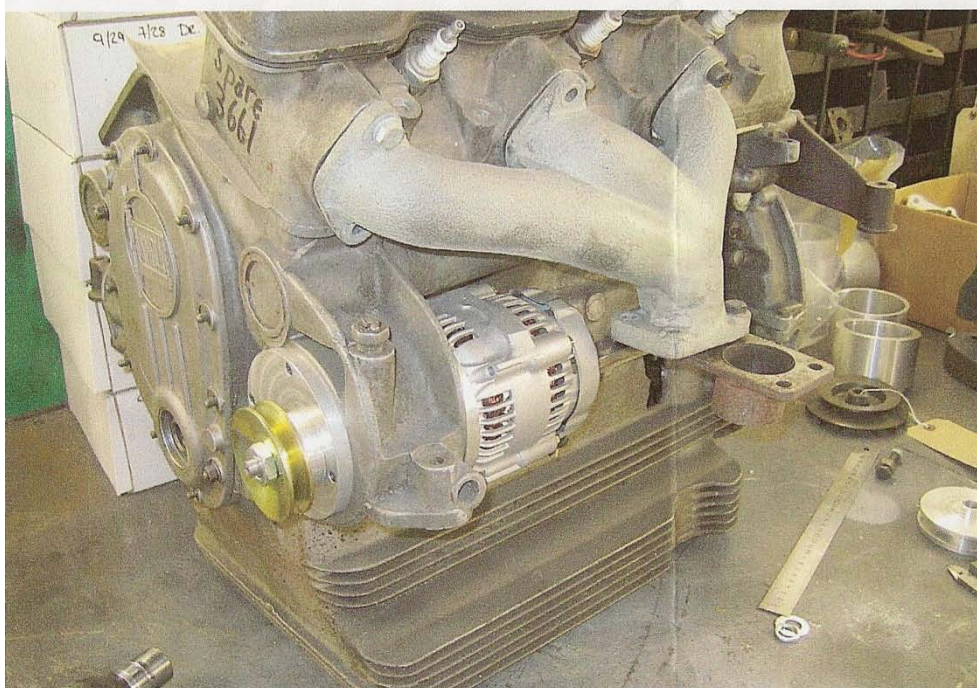
Bild 2. Växelströmsgenerator Lancia Aurelia
