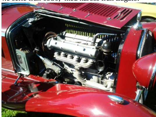
Den 6-cylindriga motorn på 1750 cc ger 85 hk vid 4500 r/m med Rootskompressor
