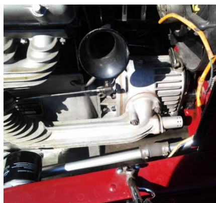
Den 6-cylindriga motorn på 1750 cc ger 85 hk vid 4500 r/m med Rootskompressor
