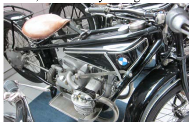
BMW R2 198 cc och R42 494 cc från 1932, vackra 2-cylindriga boxermotorer.
