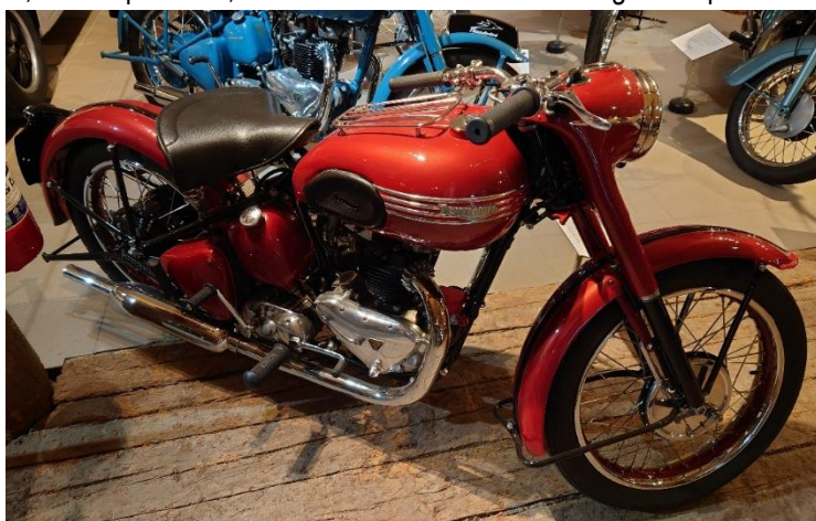
Bilden ovan: T100 Tiger, 498 cc på 32 hk, den hade smidda kolvar och högre kompression.
