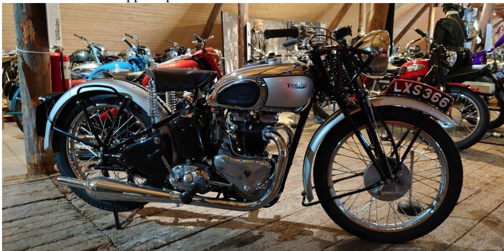
Bilden ovan: T100 Tiger, 498 cc på 32 hk, den hade smidda kolvar och högre kompression.
